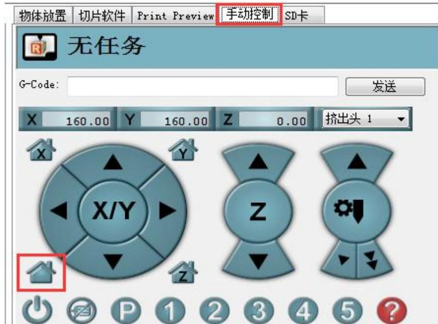
回零位置在打印机平台的**右后角**:
