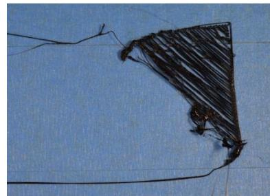
在打印时，如果第一层耗材无法正常贴于打印平台，会直接影响后期的打印效果。目前有很多企业采用不同的方法来解决第一层耗材的附着力问题，但对于常见的问题还是需要做相关的解答。
