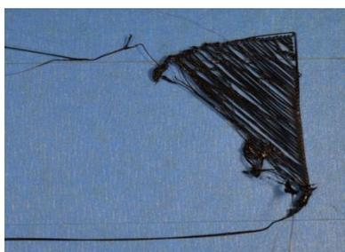
在打印时，如果第一层耗材无法正常贴于热床，会直接影响后期的打印。目前有很多企业采用不同的方法来增加第一层耗材的附着力问题，但对于常见的问题还是做相关的解答。
