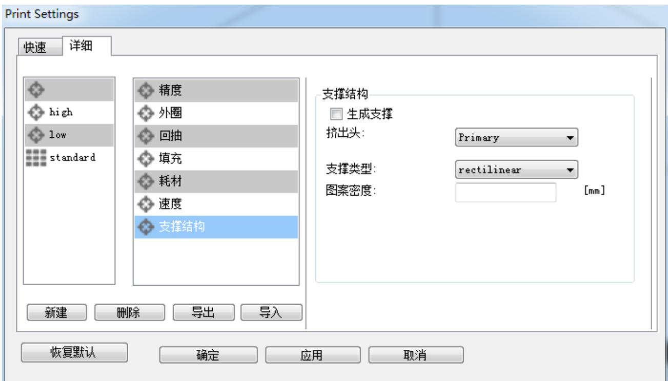
一般情况下，大多数 3D 打印模型都会有悬空部分，而这些悬空部分往往需要支撑材料作为辅助方能保证打印过程顺利进行。支撑结构的角度由几个因素共同决定，其中最显著的因素为层高和所挤出耗材的宽度，通常情况下，支撑结构的角度为 45°。需要的支撑结构越多，消耗的耗材量、打印耗时及后续的清理时间也会随之增加。
