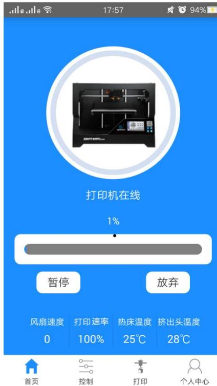
上传过程中可以暂停上传或放弃上传，上传模型完成后，机器开始加热，LCD 屏状态栏会显示打印文件名，加热完毕自动开始打印，LCD 屏 SD 卡页面首行文件显示的是刚上传的文件，APP 首页也会显示打印文件及打印进度。
