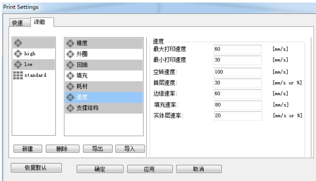
打印速度是指打印过程中挤出头转动的速度。基于该参数，EasyPrint 3D 能够精确计算出耗材的挤出速率。打印速度越高，整个打印过程的耗时越短。但是，应当注意一点，加快打印速度要求挤出机的加热温度更高，以保证耗材能够快速且优质地融化。
