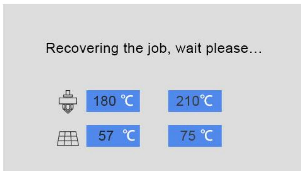
加热到目标温度后开始打印并且界面自动跳转到主界面；
