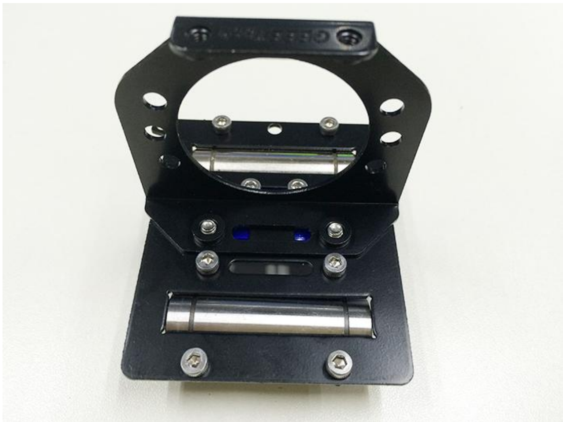
第 3 步：用 M4x6mm 螺栓把挤出机支架固定到 X 支撑正面
